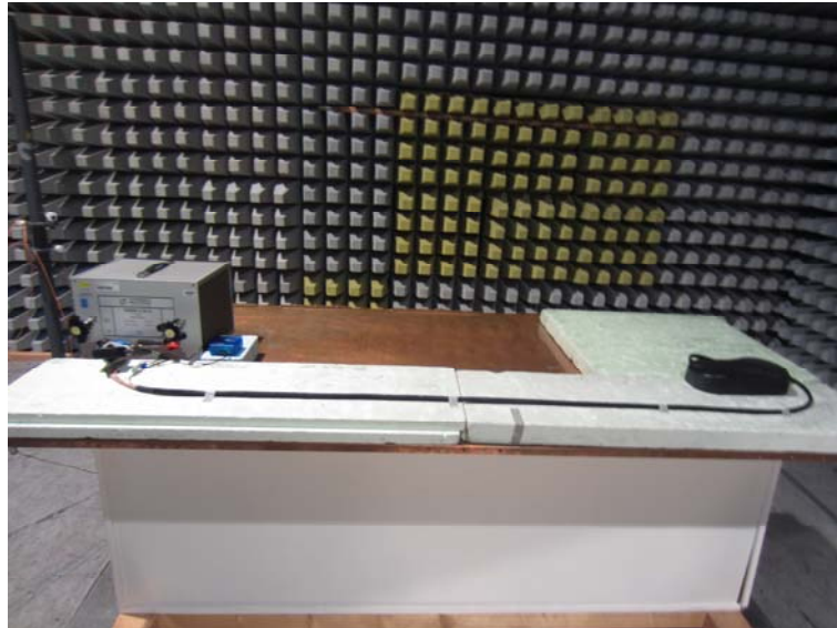
Messaufbau in der Messzelle, Kabelbaum / Test setup in the anechoic chamber, wiring harness
